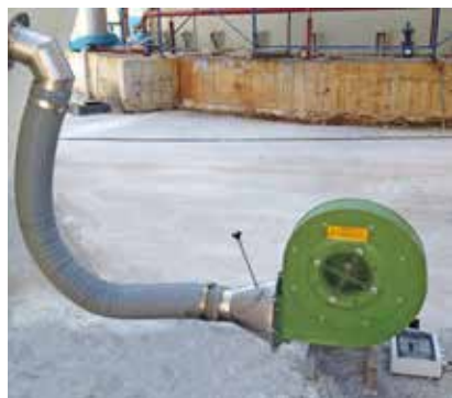
CENTRIFUGAL AIR FAN
